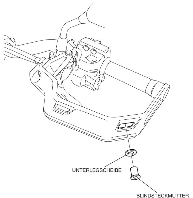
3. Montieren Sie die linke Handgriffschutzblende B wie in der Abbildung dargestellt.
