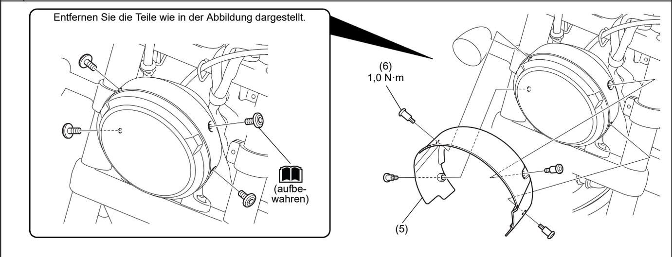
3. Montieren Sie die Teile, wie in der Abbildung dargestellt.
