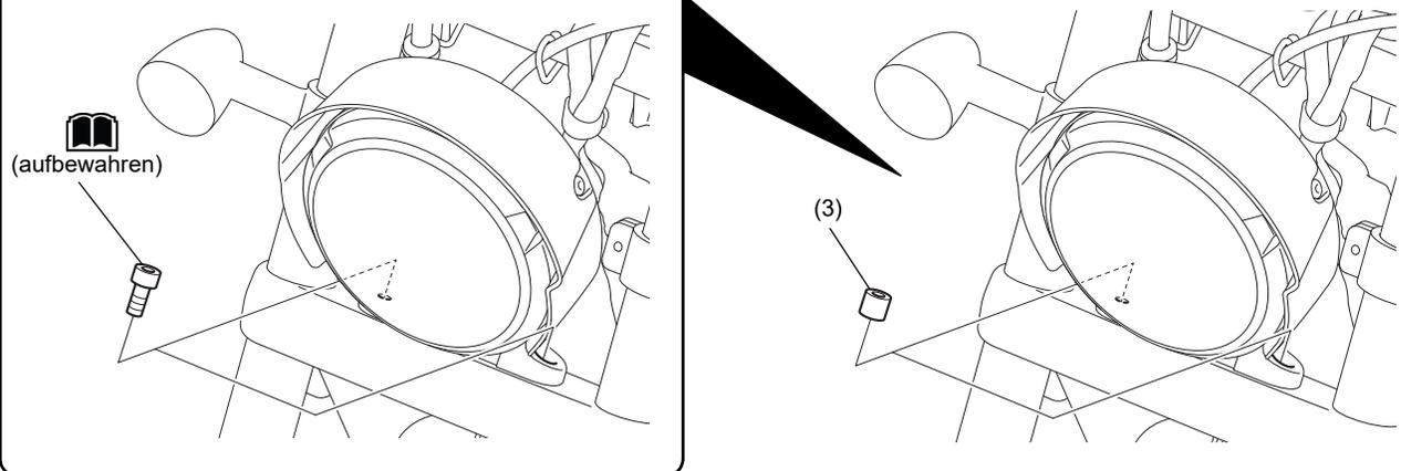
4. Montieren Sie die Teile, wie in der Abbildung dargestellt.
