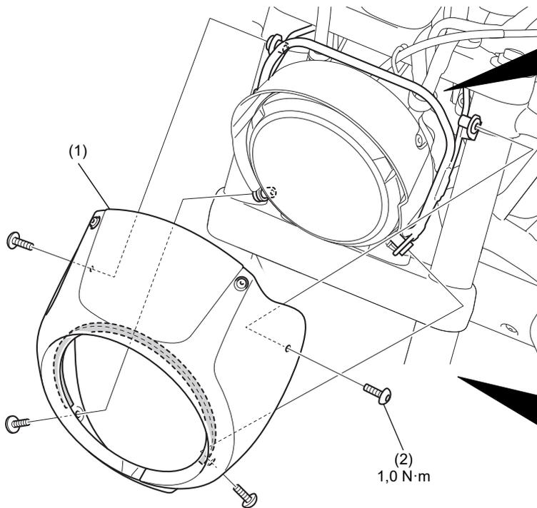
Achten Sie darauf, dass der Schaumstoff nicht aus der Scheinwerferverkleidung herausragt.
