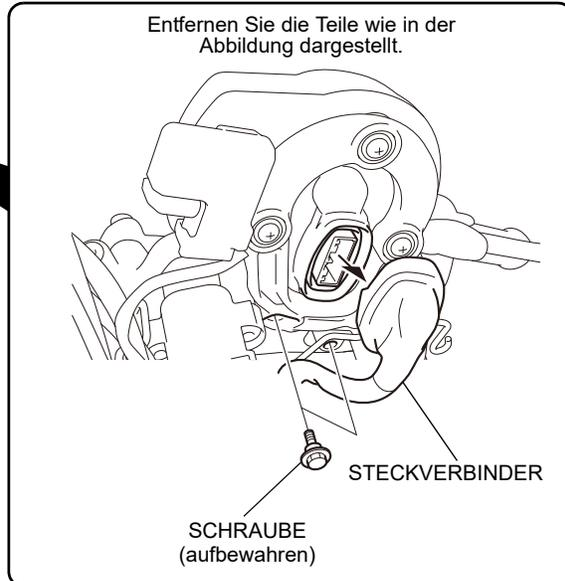
3. Montieren Sie die Teile wie in der Abbildung dargestellt, ohne sie festzuziehen.
