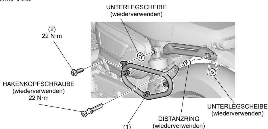
3. Montieren Sie die Teile, wie in der Abbildung dargestellt.
